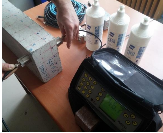
Şekil 1. Çalışmada kullanılan ultrasonik hız ölçüm ekipmanı ve direkt iletim tekniği
