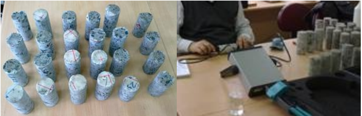
Şekil 8. Oluşturulan beton bloklardan alınan karotlar ve bir karo üzerinde ultrasonik hız ölçümü
