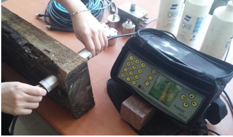
Şekil 1. Ultrasonik hız ölçüm ekipmanı ve direkt iletim tekniği
