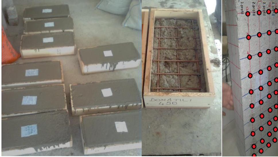
Şekil 4. Ultrasonik hız ölçümleri için hazırlanan donatısız ve donatılı beton numuneler
